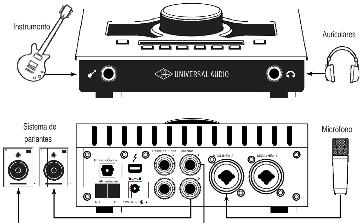
Típica configuración de conexiones de Apollo Twin MkII
